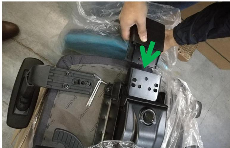
4. Вставьте один из шестигранников (можно взять с другого кресла) в отверстие нижнего винта и натяните металлическую планку так, чтобы два свободных отверстия на планке спинки и платформе сидения полностью совпали:
