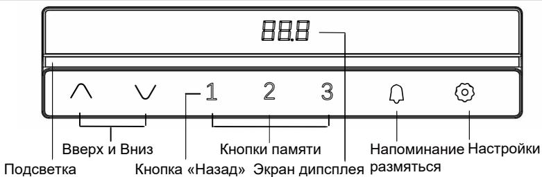
Управление осуществляется при помощи кнопок. При отсутствии нажатий в течение 30 секунд пульт переходит в спящий режим. Для активации необходимо нажать клавишу "Л" (Вверх) или "В" (Вниз). Функции доступны при включенном дисплее.
