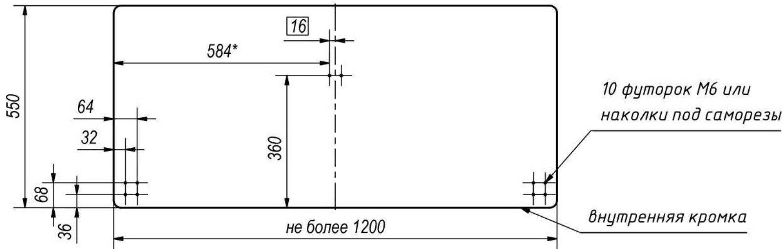
Передняя панель (толщина от 16 до 18мм)
