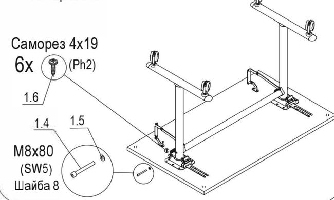
6 Установить держатель рычага на рейку механизма в соответствии с глубиной столешницы.
