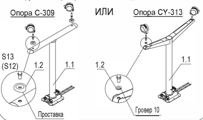
4 Закрепить вторую опору сначала к траверсе через коннектор винтом, потом к столешнице саморезами.
