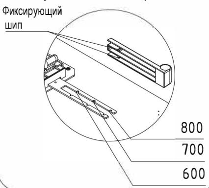
7 Вставить рычаг (поз. 2.2) во второй держатель и совместить всё с конструкцией установленной на столе. Закрепить держатели рычага саморезами через фиксирующие накладки - см. Примечание 2.
