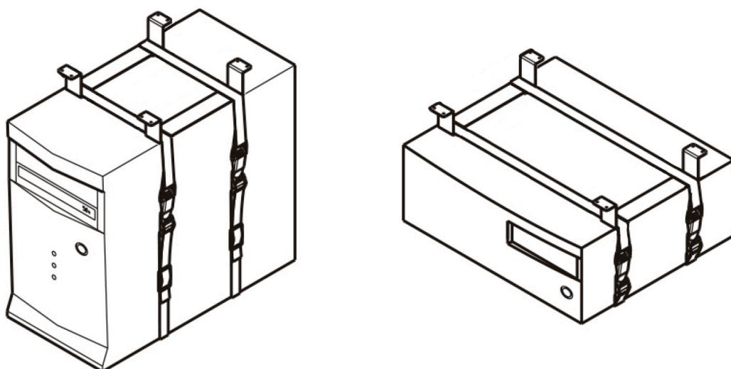
Защелкните ремни вокруг системного блока.
